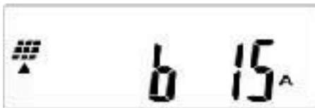
Fig. 7-4 - 9 Display O - String B current
