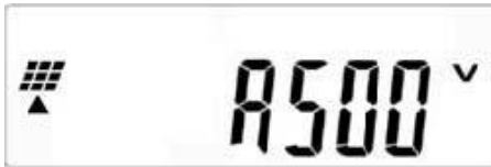
Fig. 7-4 - 6 Display L - String A voltage
