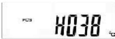
Fig. 7-4 – 3 Affichage I – Température du refroidisseur °C
