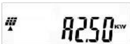
Fig. 7-4 – 10 Affichage P – Tension de sortie groupement A
