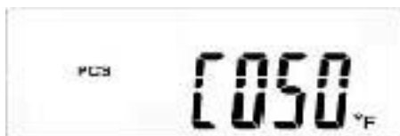
Fig. 7-4 – 4 Affichage J – Température interne °F de l'onduleur photovoltaïque
