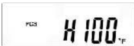
Fig. 7-4 – 5 Affichage K – Température du refroidisseur °F
