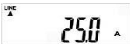
Fig. 7-4 – 14 Affichage T – Courant de sortie de l'onduleur photovoltaïque
