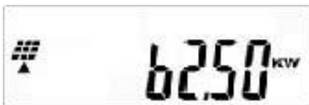
Abb. 7-4 – 11 Anzeige Q – Ausgangsleistung Strang B
