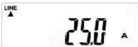
Abb. 7-4 – 14 Anzeige T – Photovoltaik-Wechselrichter Ausgangsstrom
