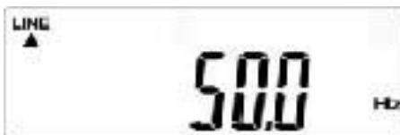
Abb. 7-4 – 13 Anzeige S – Frequenz der Photovoltaik-Wechselrichter Ausgangsspannung
