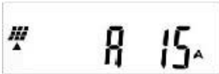
Abb. 7-4 – 8 Anzeige N – Strom Strang A
