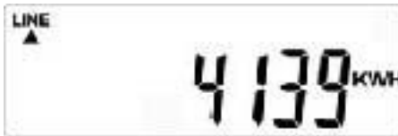
Abb. 7-4-1 Anzeige G – Gesamte Einspeiseleistung
