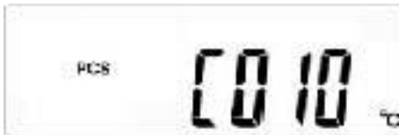
Abb. 7-4-2 Anzeige H – Photovoltaik-Wechselrichter Innentemperatur °C
