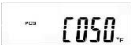
Abb. 7-4-4 Anzeige J – Photovoltaik-Wechselrichter Innentemperatur °F
