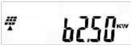
Abb. 7-4 – 11 Anzeige Q – Ausgangsleistung Strang B
