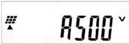
Abb. 7-4 – 6 Anzeige L – Spannung Strang A
