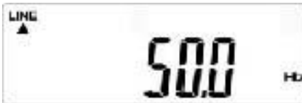
Abb. 7-4 – 13 Anzeige S – Frequenz der Photovoltaik-Wechselrichter Ausgangsspannung
