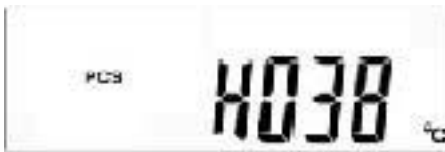
Abb. 7-4-3 Anzeige I – Temperatur Kühlkörper °C
