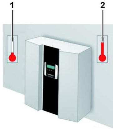
Abb. 4-2 - 1 Umgebungsbedingungen zur Montage (Temperatur)
