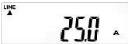
Abb. 7-4 – 14 Anzeige T – Photovoltaik-Wechselrichter Ausgangsstrom
