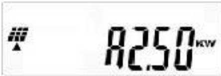
Abb. 7-4 – 10 Anzeige P – Ausgangsleistung Strang A
