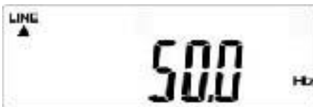
Abb. 7-4 – 13 Anzeige S – Frequenz der Photovoltaik-Wechselrichter Ausgangsspannung
