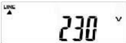
Abb. 7-4 – 12 Anzeige R – Photovoltaik-Wechselrichter Ausgangsspannung
