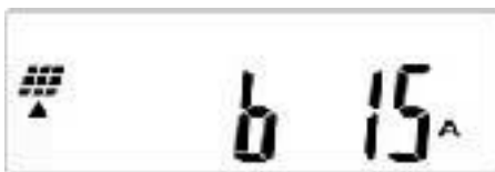
Abb. 7-4 – 9 Anzeige O – Strom Strang B
