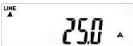
Abb. 7-4 – 14 Anzeige T – Photovoltaik-Wechselrichter Ausgangsstrom
