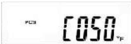
Abb. 7-4-4 Anzeige J – Photovoltaik-Wechselrichter Innentemperatur °F
