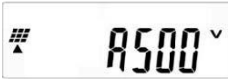
Abb. 7-4 – 6 Anzeige L – Spannung Strang A
