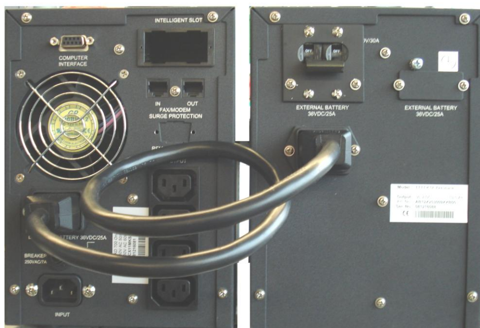
Abb. 7: Rückwand-Ansicht MKD1000 mit Akkubank
