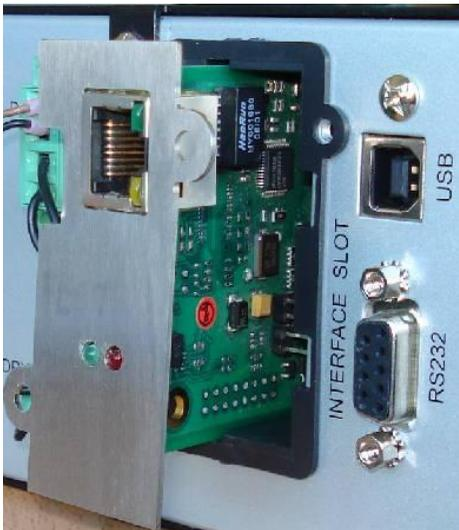
Abb. 3-2 - 2 Netzwerk-Anschluss (SNMP-Slot-Einschubkarte)
