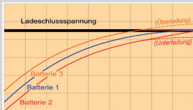
Bild oben: Ladeverlauf von Akkumulatoren mit BACS patentiertem Equalizing. Durch die Begrenzung wird Batterie 3 am „Gasen“ gehindert. Batterie 2 erhält weiterhin Energie bis auch diese die Ladeschlussspannung erreicht hat. Batterie 1 verhält sich ideal und wird nicht geregelt.
